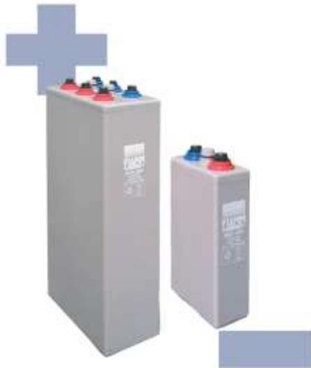
Le batterie piombo acido FIAMM della serie SMG sono del tipo regolate da valvola con elettrolito immobilizzato in forma gelatinosa. Le piastre positive sono di tipo tubulare con lega piombo - calcio. I collegamenti tra gli elementi sono completamente isolati. L'innovativo passaggio polare ad alta affidabilità garantisce assenza di corrosione durante tutta la durata di vita dei prodotti.
